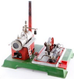
1818 Wilesco Dampfmaschine, ÜL, mit Brenner, feststehendem Zylinder und Fliehkraftregler, L 31, Z 3 10,- €
