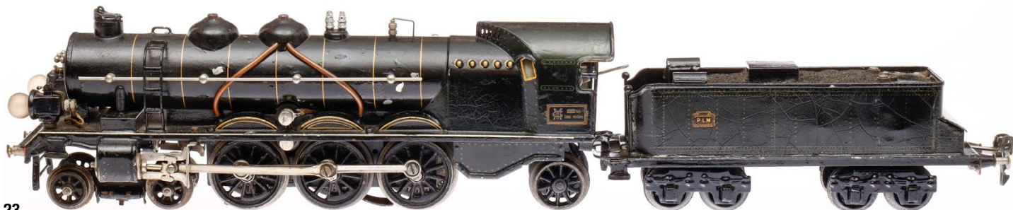
23 Märklin franz. 2-C-1 Dampflok H 64/3020 PLM, Spur 0, Starkstrom, schwarz, mit Tender und 2 el. bel. Stirnlampen, LS tw ausgebl., Tenderrahmen nachlackiert und Drehgestelle ersetzt, Lötspuren an imit. Dampfleitungen, gealterter Lack, sonst Z 2-3 1.200,- €
