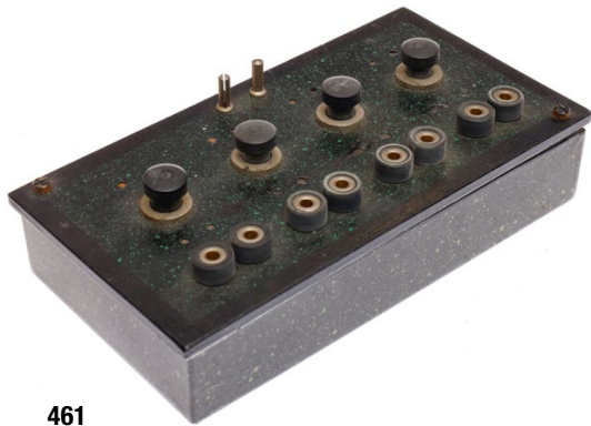
461 Märklin Ergänzungsschalter 3722, HL, mit 4 Druck-tastern und 4 doppelte Steckbuchsen, für Stellwerk-anlagen, LS und gealterter Lack, L 15, Z 2-3 20,- €
