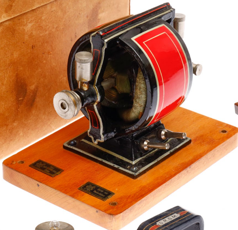
808 Märklin Starkstrommotor 3286/1, uralt, 110 Volt, HL, auf Holzsockel, komplett mit 2 Schildchen, 2 Ölern und Germany-Stempel auf Unterseite, L 14,5, im OK, Z 1, Rarität 650,- €
